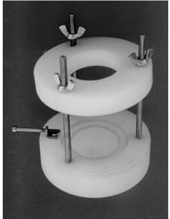
Figura 1. Soportes de nylon para el tubo de acero que constituyen la célula de electroforesis.
